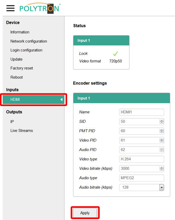
Im Monitoringfenster „**Status**“ wird das Videoformat des HDMI-Quellsignals angezeigt sowie angegeben, ob der Eingang auf dieses Signal locken konnte.
