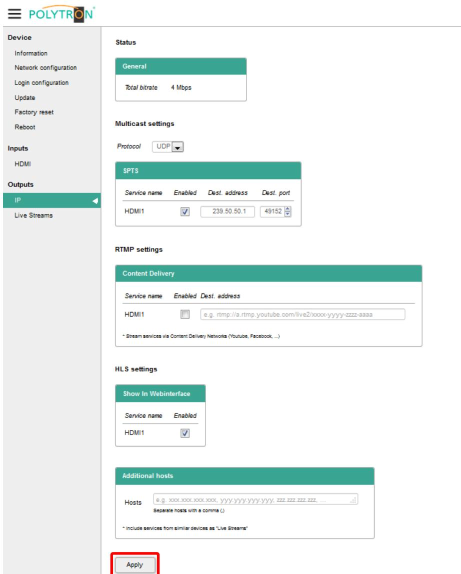
Im Monitoringfenster „**Status**“ wird die Bitrate des Ausgangssignals angezeigt.
