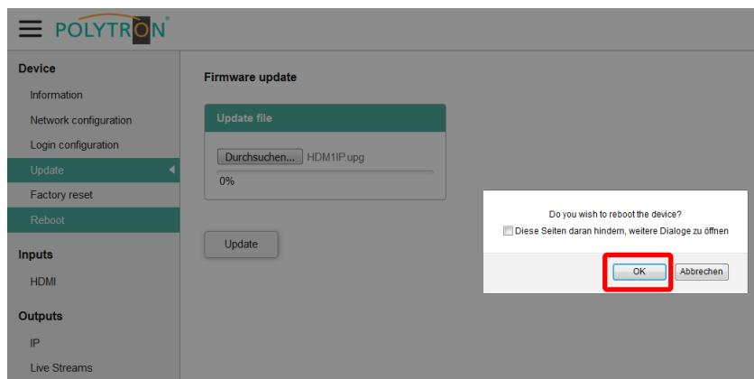
Auf dem Bildschirm wird eine Bestätigungsmeldung angezeigt, um den Neustart zu bestätigen. Nach Betätigen des Buttons „**OK**“ wird der Neustart ausgeführt. Nach erfolgreichem Neustart wird das zuletzt aktivierte Menü angezeigt.
