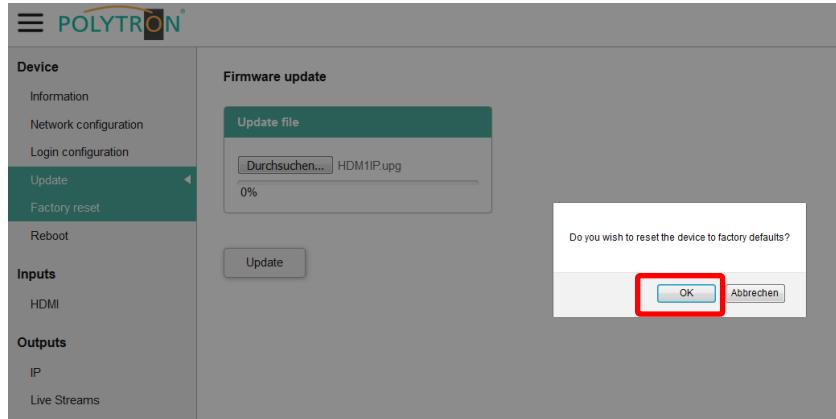
Auf dem Bildschirm wird eine Bestätigungsmeldung angezeigt, um das Rücksetzen auf die Werkseinstellungen zu bestätigen. Nach Betätigen des Buttons „**OK**“ wird das Rücksetzen ausgeführt.
